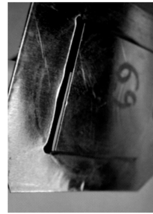
5. ábra Kis szélhulladék miatt nem teljesen körbevágott munkadarab
