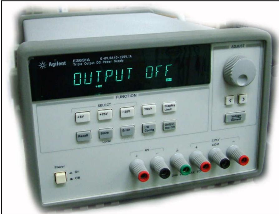
Es gibt auch Geräte, die Single- und Dual-Netzteile in einem gemeinsamen Gehäuse enthalten. Das symmetrische Netzteil verfügt über keinen erdfreien GND. Sein zentraler Anschluss ist galvanischer
